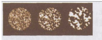
图3 连通性由差到好的球状随机储层模型
