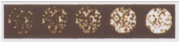
图2 小孔密度递增的球状随机储层模型
